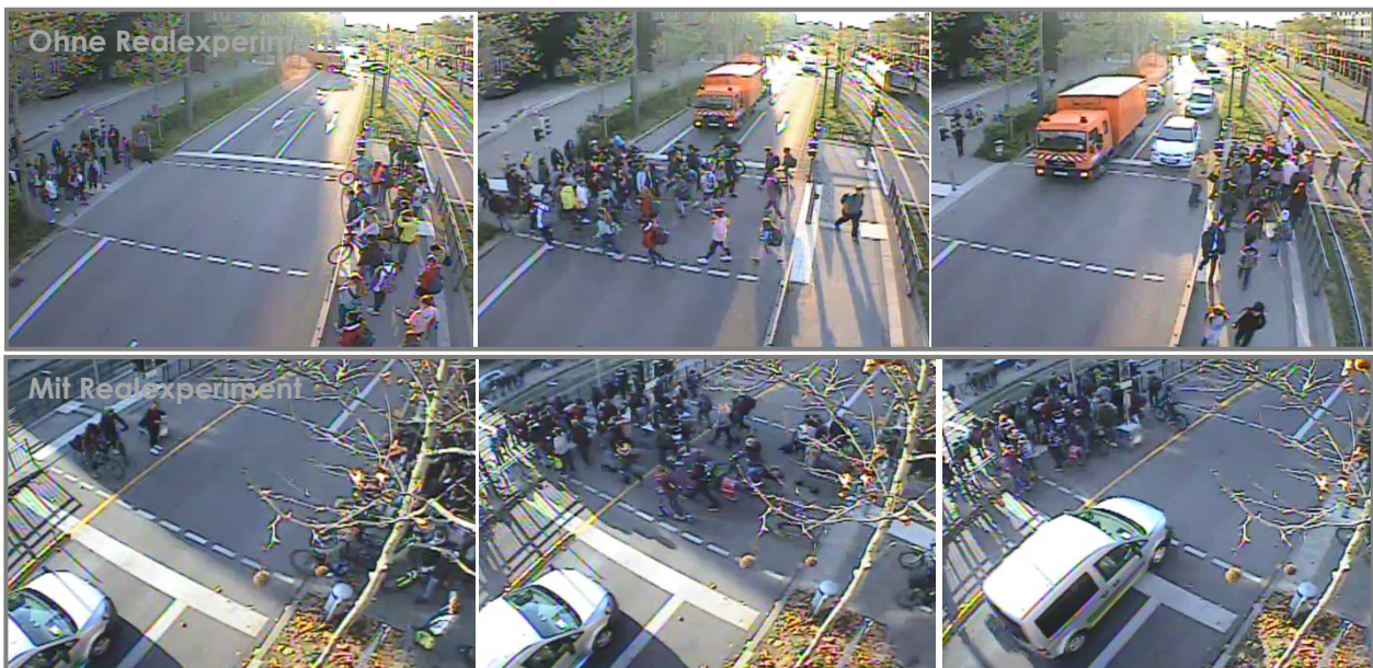
Abbildung 5: Situation an der Aufstellfläche Haltestelle Mühlburger Tor. Die durch den Wegfall des Fahrstreifens freigewordenen Flächen ermöglichen ein sicheres Warten von Fußgängerinnen und Fußgängern
