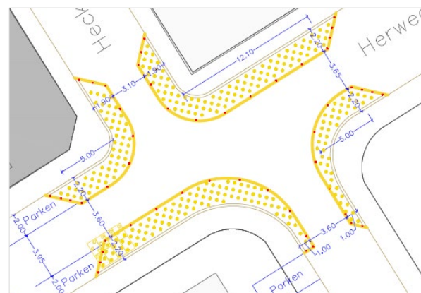
Abbildung 2: Asymmetrische Kreuzung erschwert das direkte Queren von zu Fuß Gehenden
