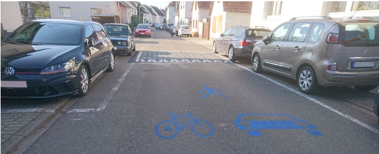
Abbildung 2: Maßnahmenkombination aus Plateaukissen und Markierung zur Geschwindigkeitsreduktion und besseren Verträglichkeit zwischen den Verkehrsteilnehmenden
