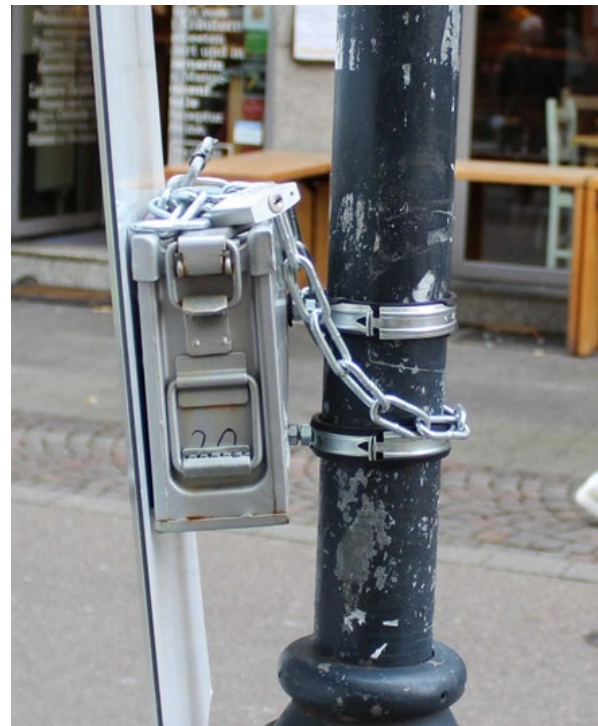
Abbildung 4: Seitenansicht eines interaktiven Posters mit Blick auf Metallbox und Befestigung
